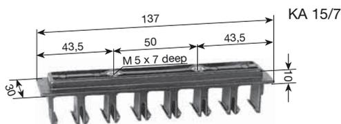
Conductor spacing 18 mm.
